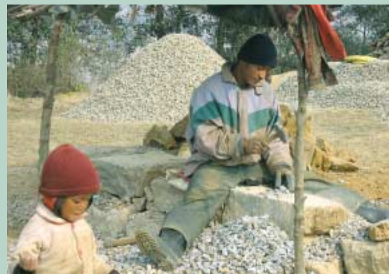
Makadamtillverkning i vägkanten.
